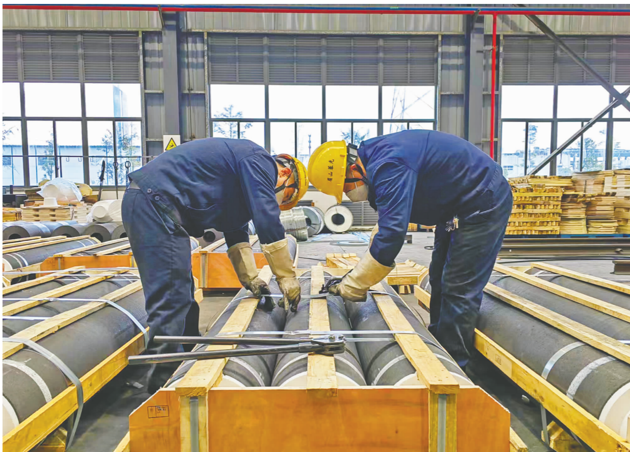
工人正在检验石墨电极产品接头成品。(图据6月18日《眉山日报》)
