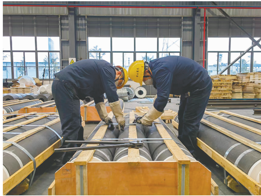
工人正在检验石墨电极产品接头成品。
