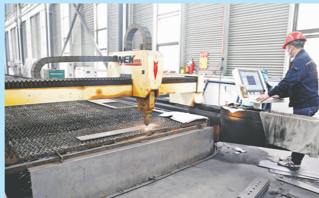
激光切割钢板材。
