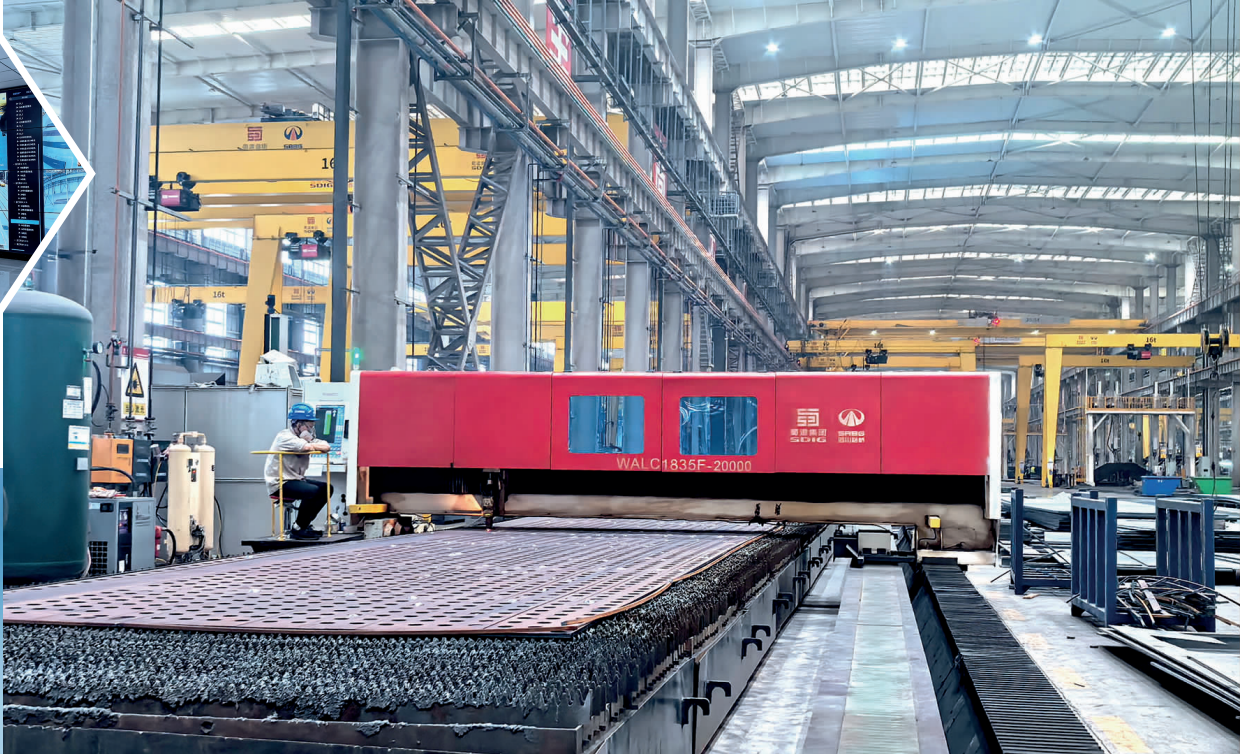
激光切割机正在切割钢板。
