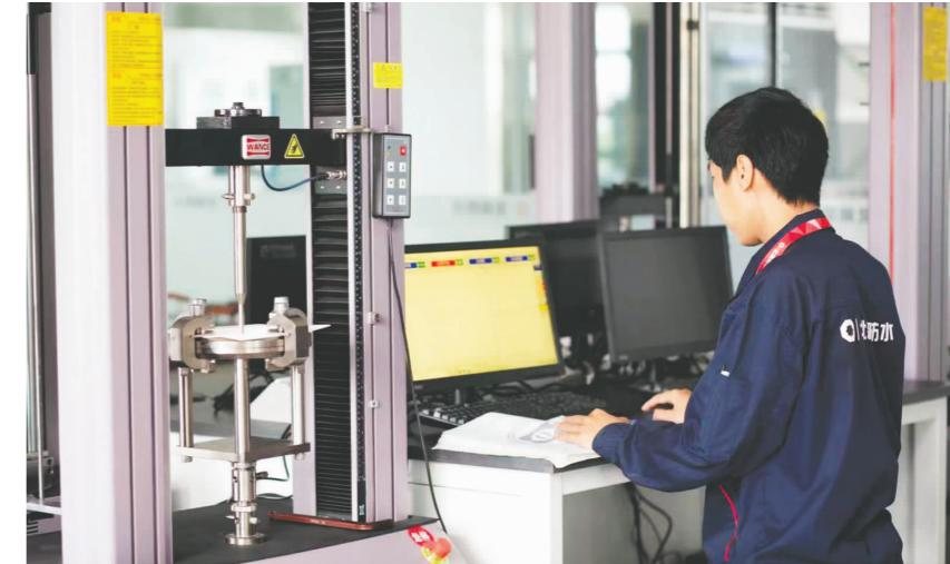
公司技术人员正在用精密设备检测产品的关键指标之一——拉力值。
