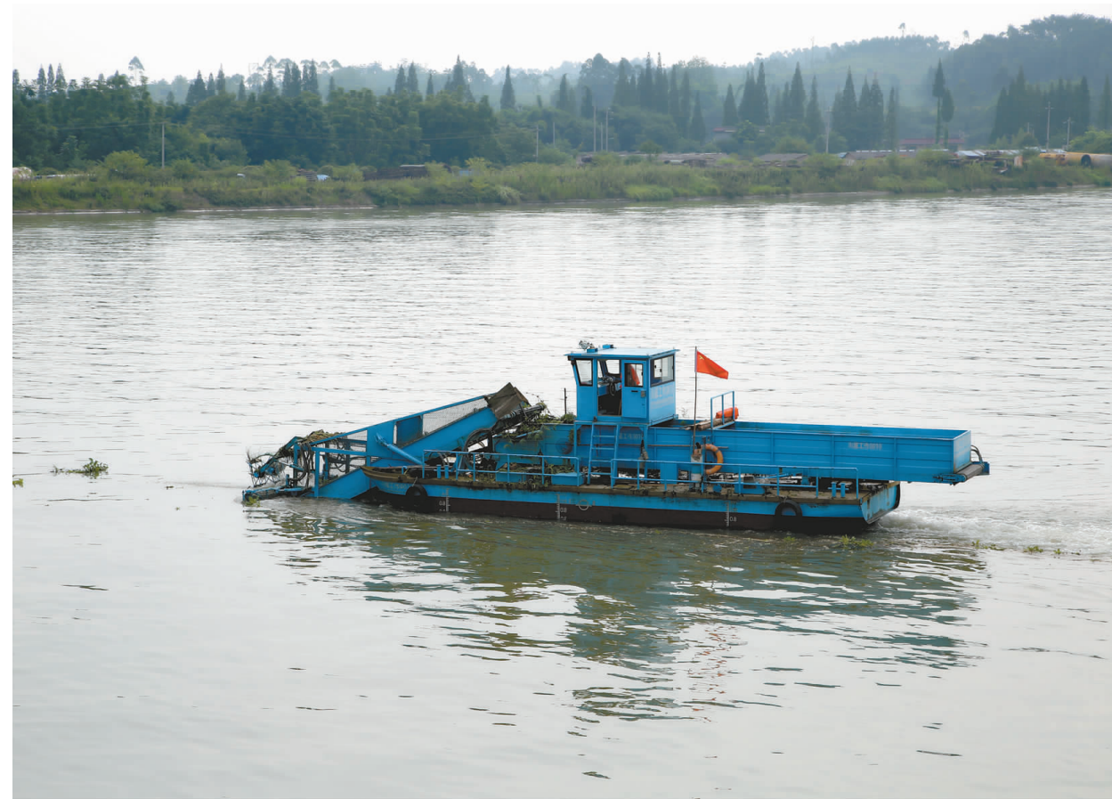
8月4日,在青神县岷江汉阳段,一艘打捞船正在进行漂浮物打捞清理作业,确保河面干净、整洁。
